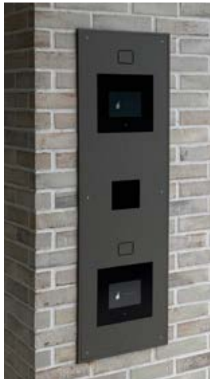
+ Zwei COMFORT 5,7“ Türstationen für barrierefreien Zutritt in Anlehnung an DIN 18040 in Unterputzgehäuse RAL 7039 mit Winkelrahmen sowie Ausschnitt für bauseitigen Kartenleser.
