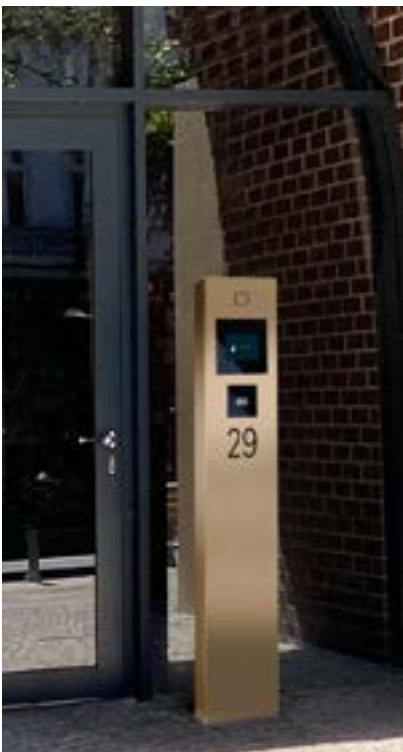
+ 5,7“ COMFORT Türstation, eingebaut in einer freistehenden Stele in der Sonderfarbe Perlbeige matt dry-blend pulverbeschichtet, Hausnummerngravur und Ausschnitt für bauseitigen Kartenleser.
