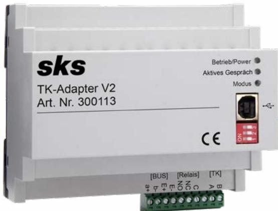
Der TK-Adapter V2 stellt eine Verbindung zwischen dem SKS BUS und einer Telefonanlage her. Alle Telefone, die mit dem TK-Adapter V2 kommunizieren, müssen DTMF-fähig sein. Der TK-Adapter V2 benötigt einen analogen Anschluss-Port an der TK-Anlage. Mit dem TK-Adapter V2 ist es möglich, bis zu 15 Klingeltasten mit der Telefonanlage zu verbinden. Es können also bis zu 15 Rufnummern von dem TK-Adapter V2, je nach gedrückter Klingeltaste, gewählt werden.
