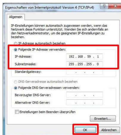
Nachdem Sie alle Türstationen konfiguriert haben, sollten Sie die zuvor getätigten Änderungen wieder löschen. Löschen Sie dazu die IP-Adresse und die Subnetzmaske wieder. Markieren Sie den Punkt „IP-Adresse automatisch beziehen“.
