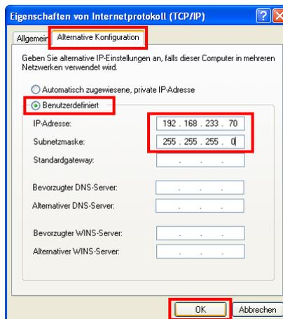
Nachdem Sie alle Türstationen konfiguriert haben, sollten Sie die zuvor getätigten Änderungen wieder löschen. Löschen Sie dazu die IP-Adresse und die Subnetzmaske wieder. Markieren Sie den Punkt „Automatisch zugewiesene, private IP-Adresse“ auf der Registerkarte „Alternative Konfiguration“.
