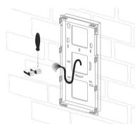
Schließen Sie die Anschlussklemmen an das zuvor verlegte Kabel an. Die Anschlussklemmen finden Sie auf der Rückseite der il vetro Video Innensprechstelle.
