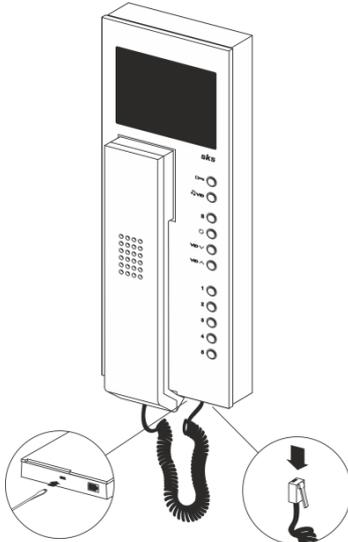
Lösen Sie die Innensprechstelle von dem Geräteträger, indem Sie mit dem Schraubendreher in die Entriegelungsöffnung auf der Unterseite der Innensprechstelle hineindrücken.
