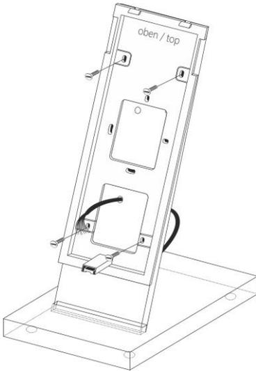
Montieren Sie den Geräteträger anschließend mit den mitgelieferten Schrauben an dem Tischmontageset. Benutzen Sie dazu die Befestigungslöcher im oberen und unteren Bereich des Geräteträgers.
