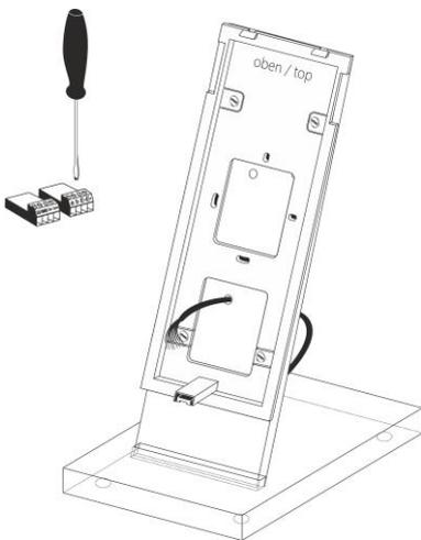
Schließen Sie die Anschlussklemmen an das Anschlussadapterkabel an. Die Anschlussklemmen finden Sie auf der Rückseite der Innensprechstelle.
