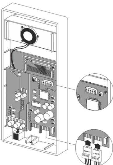
Stecken Sie die Anschlussklemmen auf die Rückseite der Innensprechstelle auf und stellen Sie die SKS-Bus Rufadresse an dem DIP-Schalter auf der Rückseite der Innensprechstelle ein. Jede Adresse ist einem Klingeltaster an der Türstation zugeordnet. Die SKS-Bus Rufadressentabelle befindet sich im Anhang.
