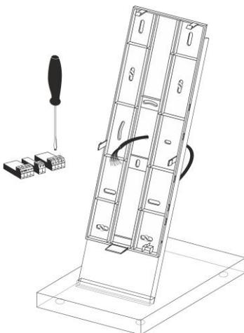
Schließen Sie die Anschlussklemmen an das Anschlussadapterkabel an. Die Anschlussklemmen finden Sie auf der Rückseite der Innensprechstelle.
