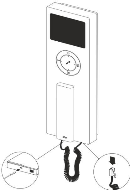
Lösen Sie die Innensprechstelle von dem Geräteträger, indem Sie mit dem Schraubendreher in die Entriegelungsöffnung auf der Unterseite der Innensprechstelle hineindrücken.
