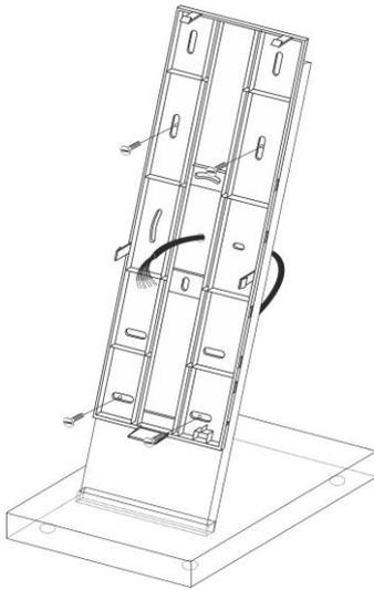
Montieren Sie den Geräteträger anschließend mit den mitgelieferten Schrauben an dem Tischmontageset. Benutzen Sie dazu die Befestigungslöcher im oberen und unteren Bereich des Geräteträgers.
