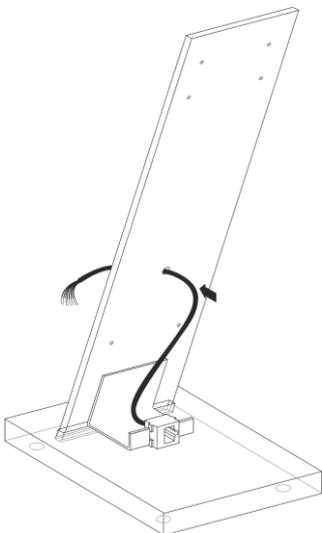
Auf der Rückseite des Tischmontagesets befindet sich der Anschlussadapter.
