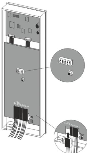
Stecken Sie die Anschlussklemmen auf die Rückseite der Innensprechstelle auf und stellen Sie die SKS-Bus Rufadresse an dem DIP-Schalter auf der Rückseite der Innensprechstelle ein. Jede Adresse ist einem Klingeltaster an der Türstation zugeordnet. Die SKS-Bus Rufadressentabelle befindet sich im Anhang.
