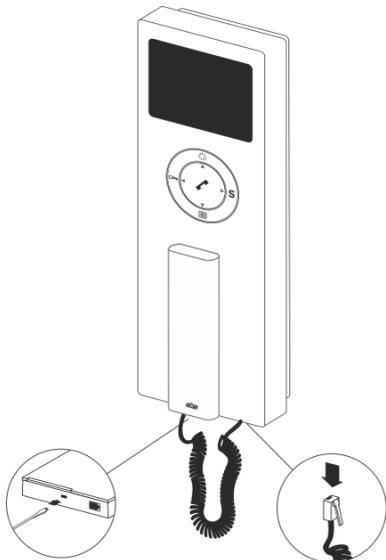
Lösen Sie die Innensprechstelle von dem Geräteträger, indem Sie mit dem Schraubendreher in die Entriegelungsöffnung auf der Unterseite der Innensprechstelle hineindrücken.
